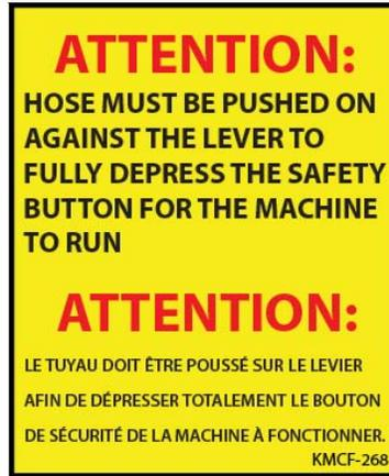
Tuyaux doivent être contre le levier à actionner l'interrupteur de sécurité pour machine à courir.
