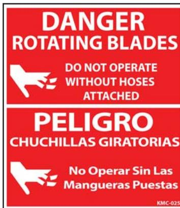
Le souffleur en rotation risque d'être dangereux ! Les vêtements amples, les cheveux, les mains, etc. peuvent être aspirés dans la chambre de l'aspirateur. Bien fixer les flexibles avant la mise en fonctionnement. Dans le cas contraire, il y a un risque de blessures graves ou de mort.
