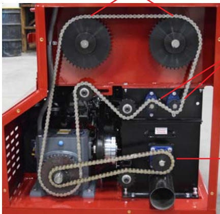
Agitator Grease Fittings (2 per side)
