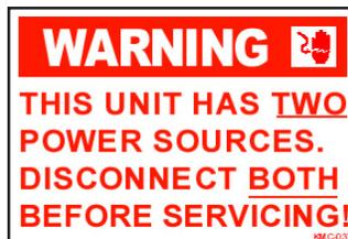
Indique que l'unité comporte deux sources d'alimentation électrique qui doivent être débranchées avant l'entretien afin de réduire le risque de blessures graves ou de mort.
