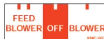
Zeigt an, ob das Gebläse aus, ein oder eingeschaltet mit Rührwerk ist.
