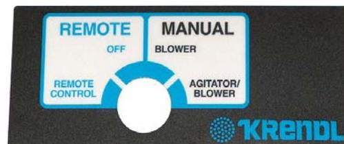
Zeigt an, ob sich die Maschine in Fernsteuerung, manuellem Modus oder in ausgeschalteter Position befindet. Im manuellen Modus betreibt diese Schalter die Maschine. Im Modus Fernsteuerung betreibt das Handbediengerät die Maschine. Jedes Mal, wenn ein Maschinenzklus startet, warnt ein hörbarer Alarm das Bedienungspersonal, dass die Maschine startbereit ist und anlaufen wird.
