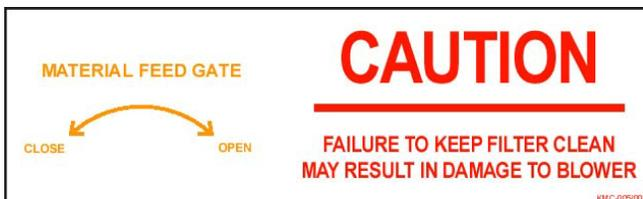
Indica la forma en que se abre y cierra la compuerta de alimentación de material, lo que a su vez controla la producción, y aclara que conservar limpio el filtro alarga la vida útil del soplador y mejora el funcionamiento.
