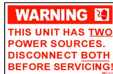
Indica que esta unidad tiene dos fuentes de alimentación de corriente que deben ser desconectadas antes de realizar un mantenimiento, a fin de reducir el riesgo de lesiones graves o muerte.
