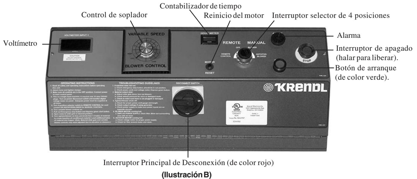
6. Cuando funciona en **Modo Remoto**, el Selector de 4 posiciones se debe colocar en posición **Remoto**. (favor referirse a la ilustración B).
